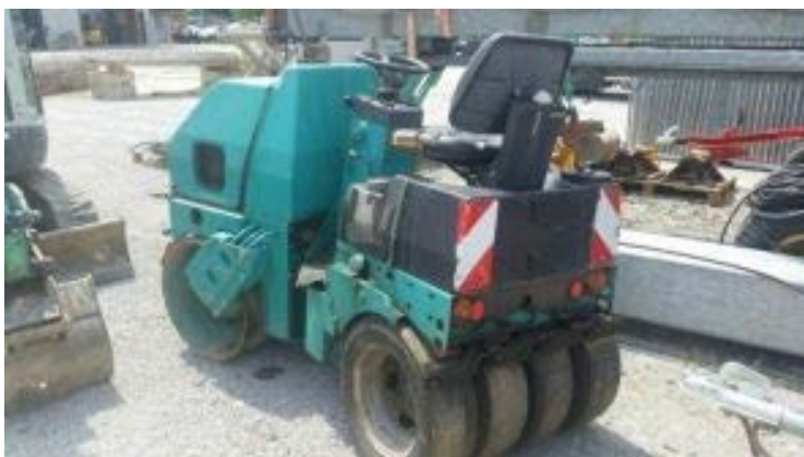
Kombiwalze: Glattmantel- und Gummiradbandage – Erstverdichtungsgerät für Decktragschichten
